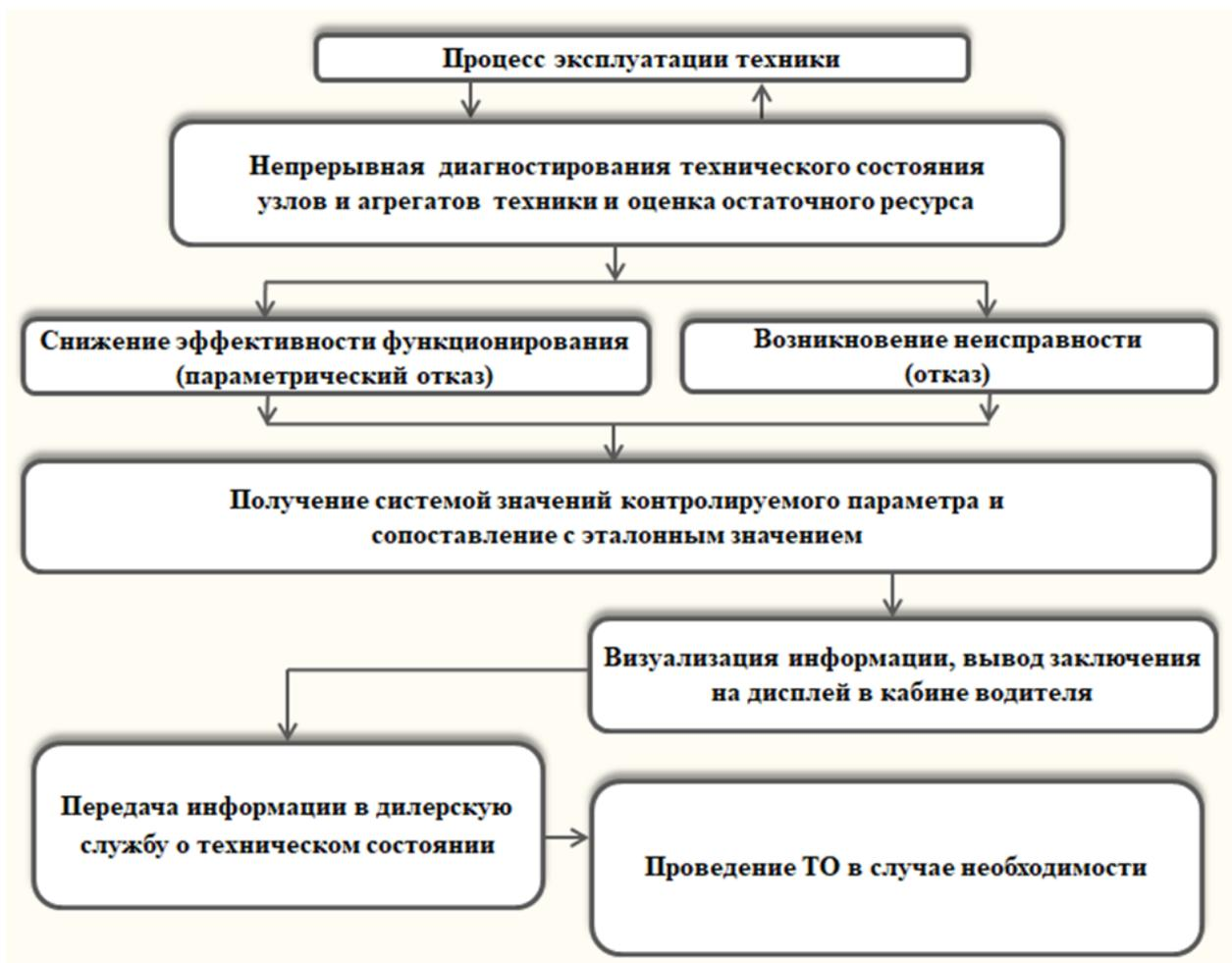
Рисунок 4.4 – Методика непрерывного диагностирования технического состояния узлов и агрегатов автотранспортных средств
