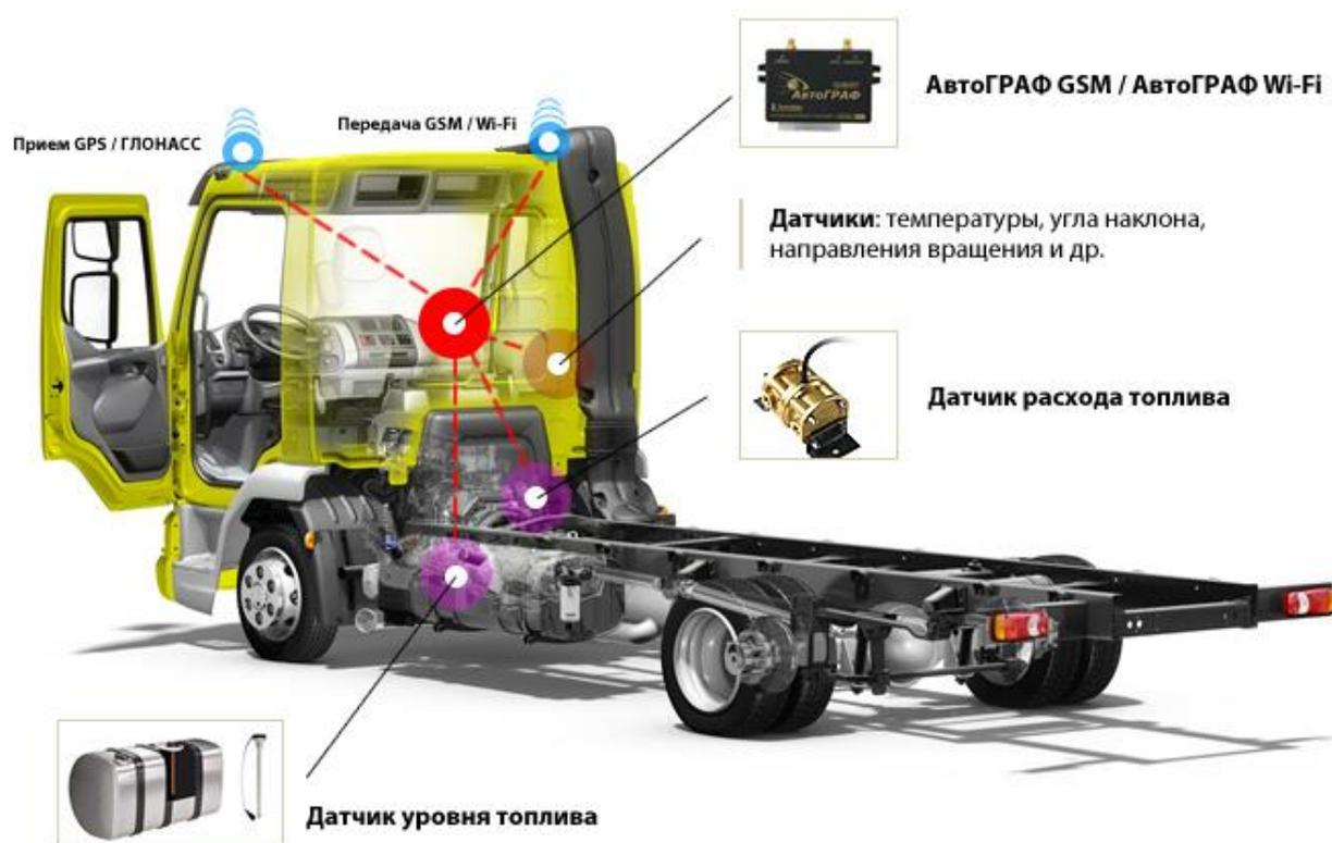
Рисунок 1.8 - Пример установки оборудования для дистанционного мониторинга техники
