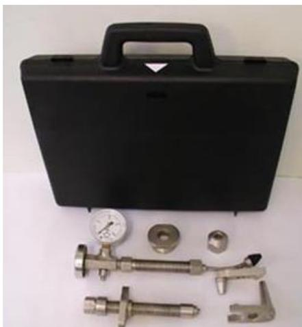
Рисунок А.3 – Универсальный компрессометр КИ-28125
