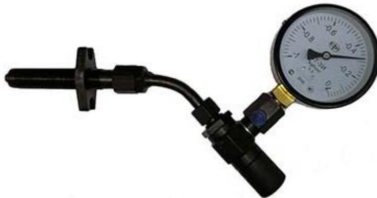
Рисунок А.2 – Вакуум-анализатор цилиндро-поршневой группы КИ-28165
