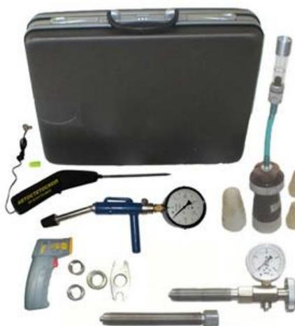
Рисунок А.1 – Модуль переносной средств контроля цилиндро-поршневой группы дизеля КИ-28134М
