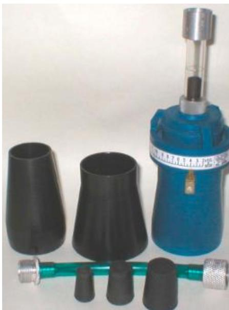
Рисунок А.4 – Расходомер картерных газов (модернизированный) КИ-17999М
