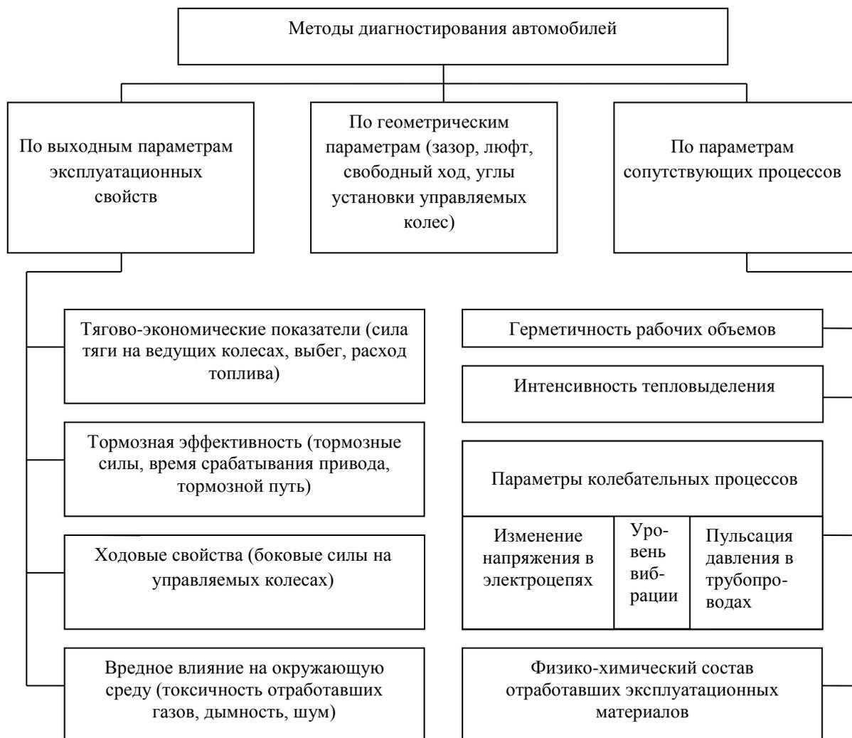
Рисунок 7 – Методы диагностирования автомобилей
