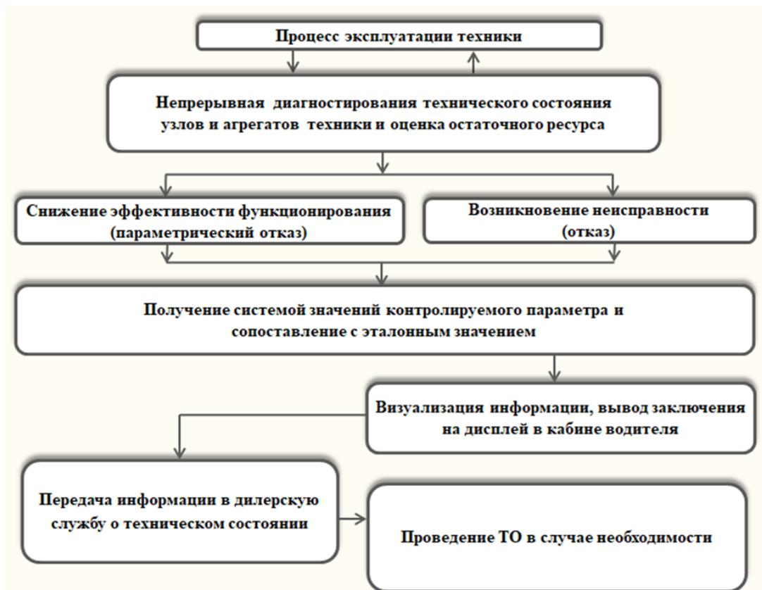
Рисунок 16 – Методика непрерывного диагностирования технического состояния узлов и агрегатов автотранспортных средств
