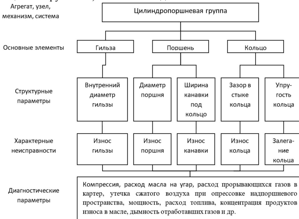
Рисунок 9 – Структурно-следственная схема цилиндропоршневой группы двигателя как объекта диагностирования
