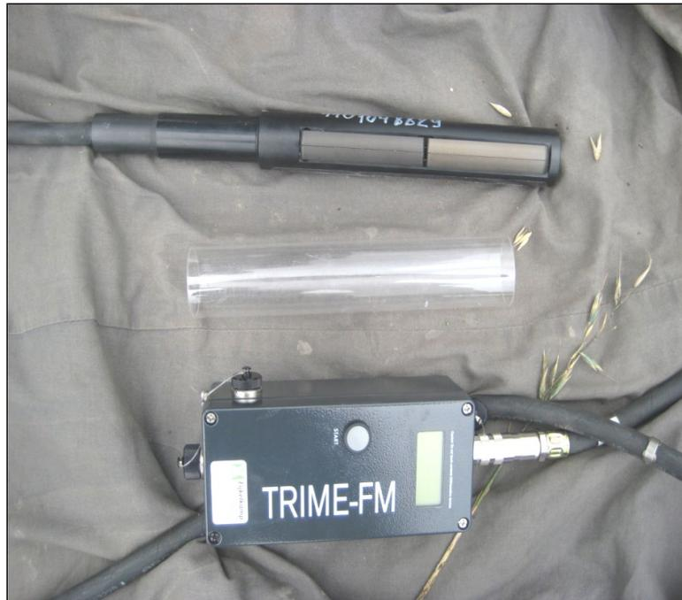
Рисунок 2.1.4 – Прибор для измерения влажности почвы TRIME-FM
