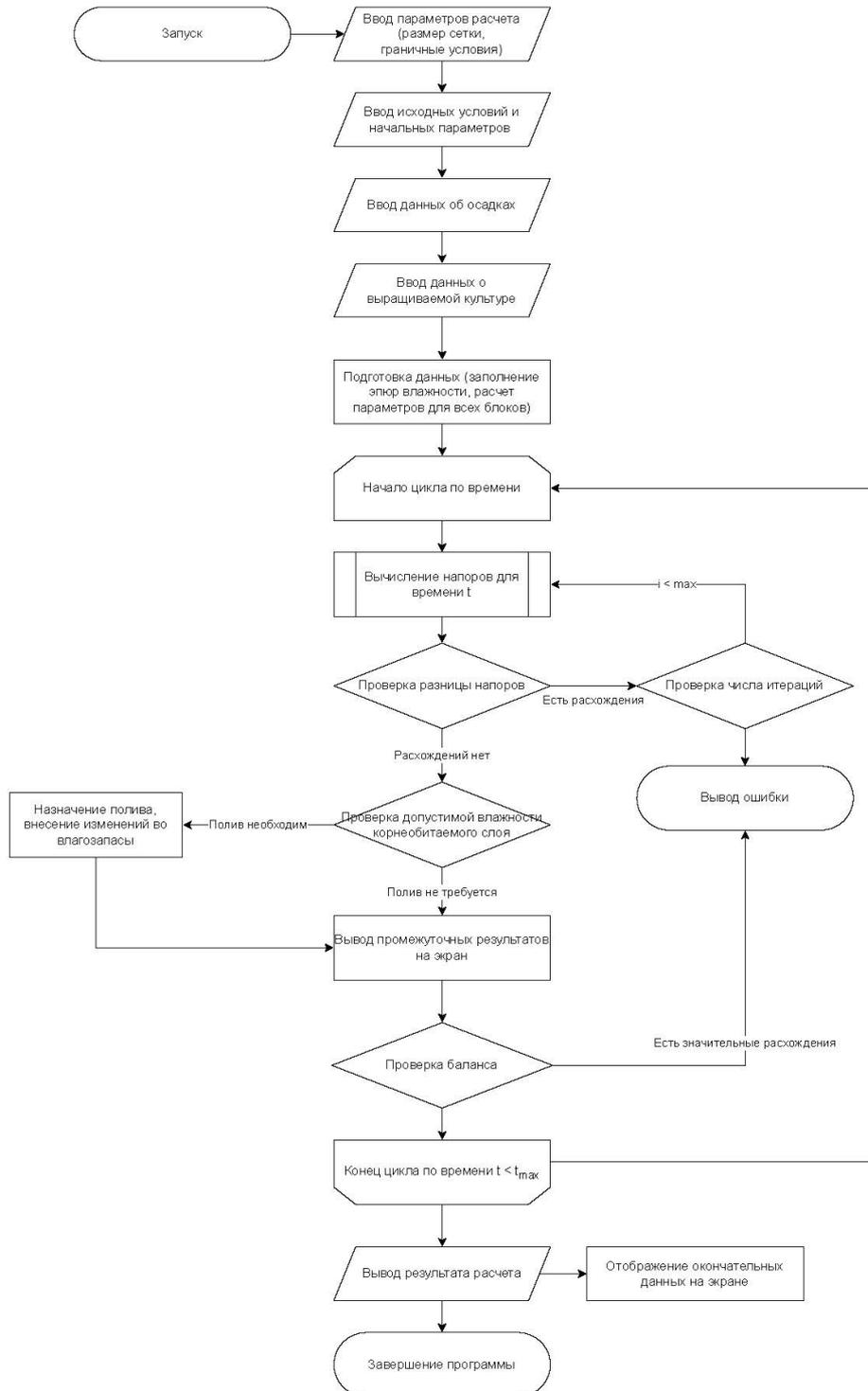
Рисунок К.1 – Блок схема программы «Полив» А.И. Голованова
