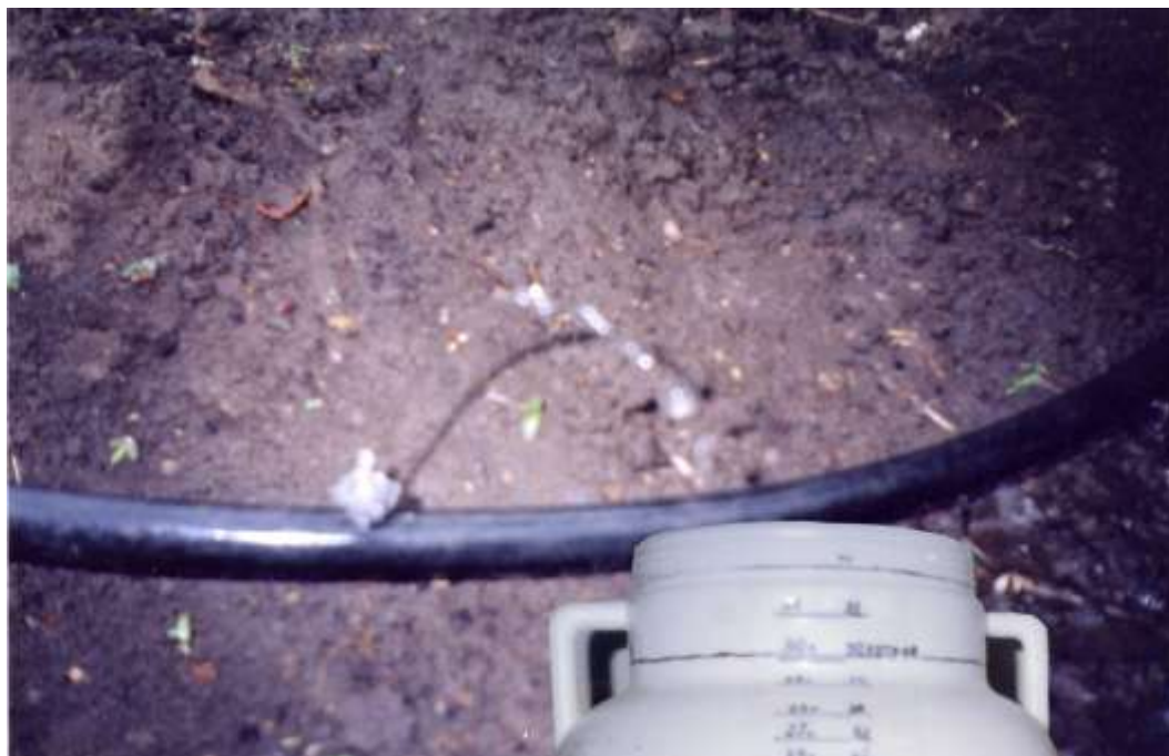
Рисунок 4.3 – Измерение расхода в водовыпусках с помощью тарированной ёмкости
