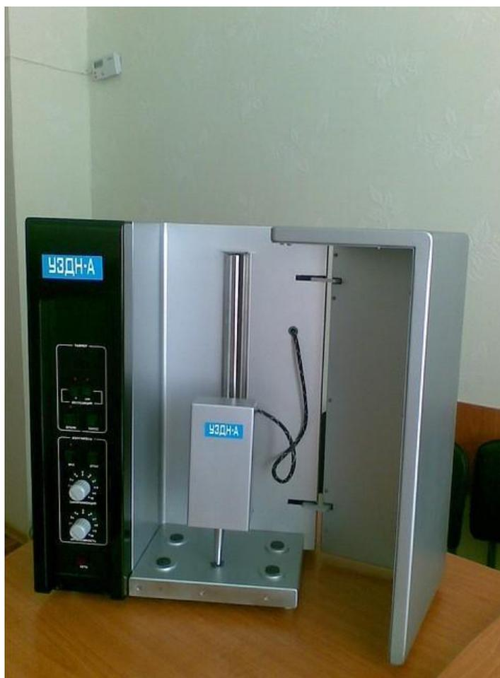
Рисунок 3.1 – Ультразвуковая установка «УЗДН-А» с постоянной частотой колебаний
