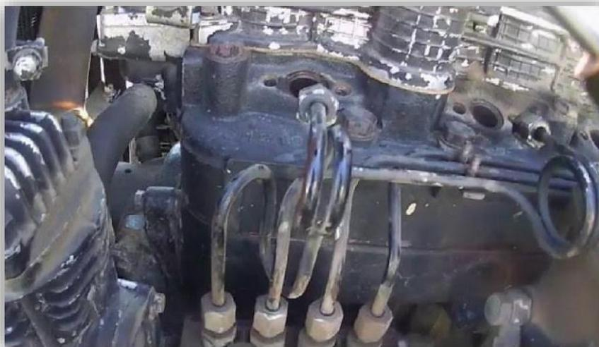
Рисунок 4.21 – Детали сельскохозяйственной техники трактора МТЗ в виде распылителя топливной форсунки двигателя МТЗ-82
