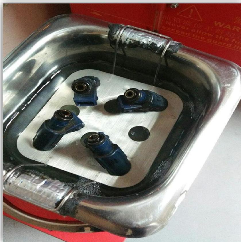
Рисунок 4.20 – Резервуар для жидкого раствора объёмом 5 литров
