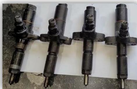
Рисунок 4.23 – Детали сельскохозяйственной техники трактора МТЗ в виде распылителя топливной форсунки двигателя МТЗ-82 после процесса очистки по технологии ультразвуковой очистки
