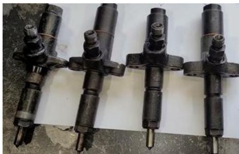
Рисунок 13 – Детали сельскохозяйственной техники трактора МТЗ в виде распылителя топливной форсунки двигателя МТЗ-82 после процесса очистки по технологии ультразвуковой очистки
