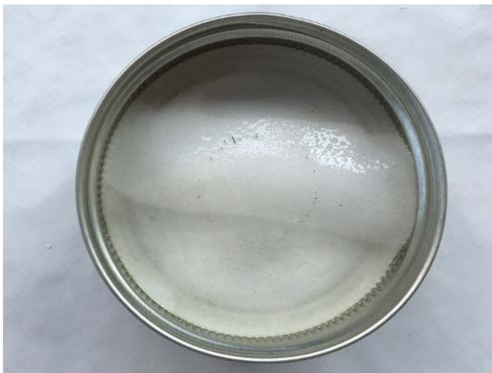
Рисунок 3.10 – МТ-F Обработанные водно-спиртовым раствором (50:50).
