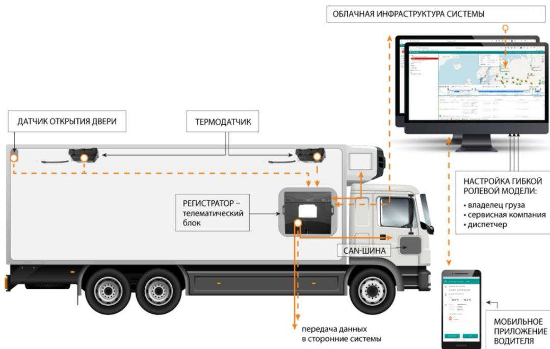
Рисунок 4 – Архитектура программно-аппаратного комплекса
