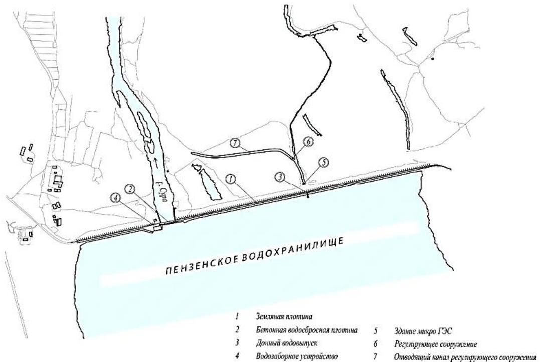
Рисунок 5.2 – Генплан Сурского гидроузла
