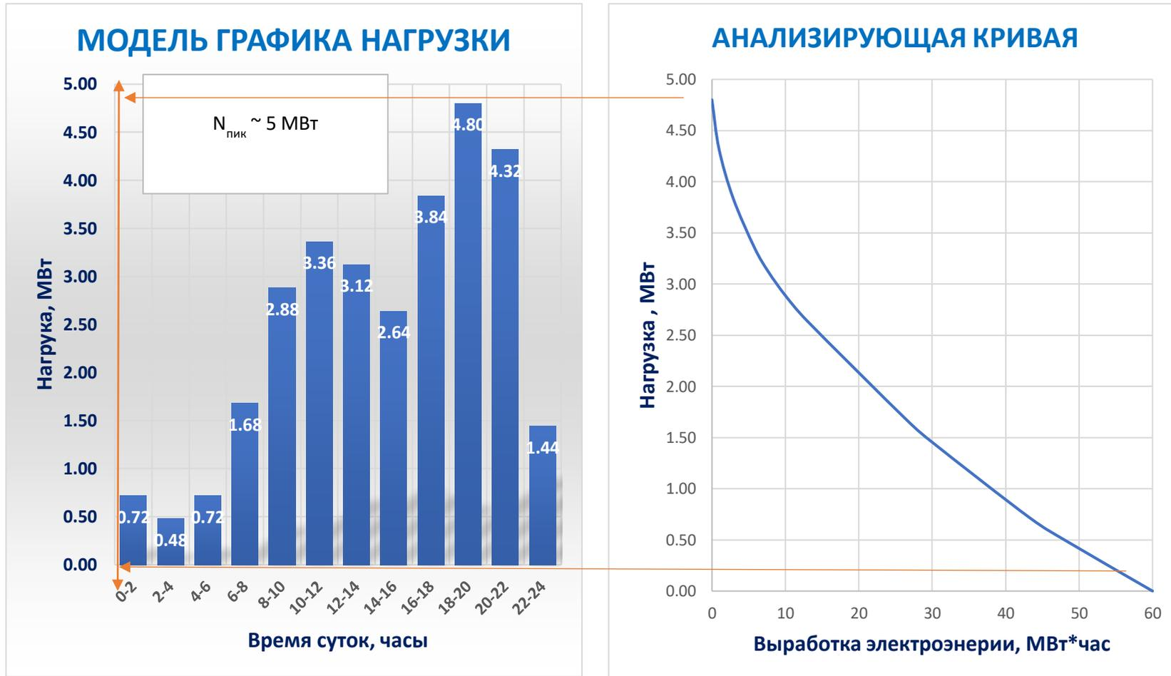
Рисунок 5.5 – Суточное регулирование мощности микро ГЭС в составе Пензенского гидроузла
