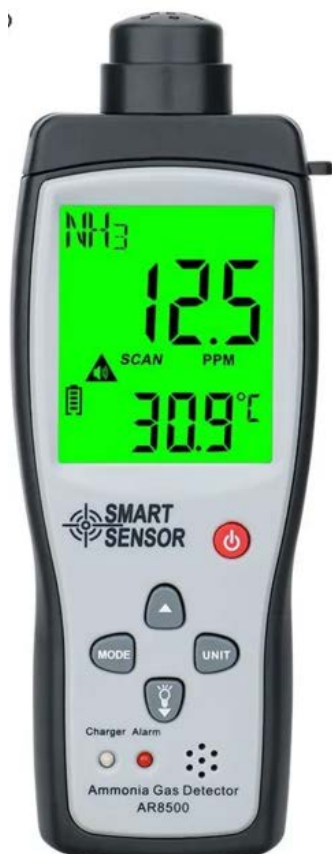
Рисунок 3.24 – Газоанализатор Smart Sensor AR8500
