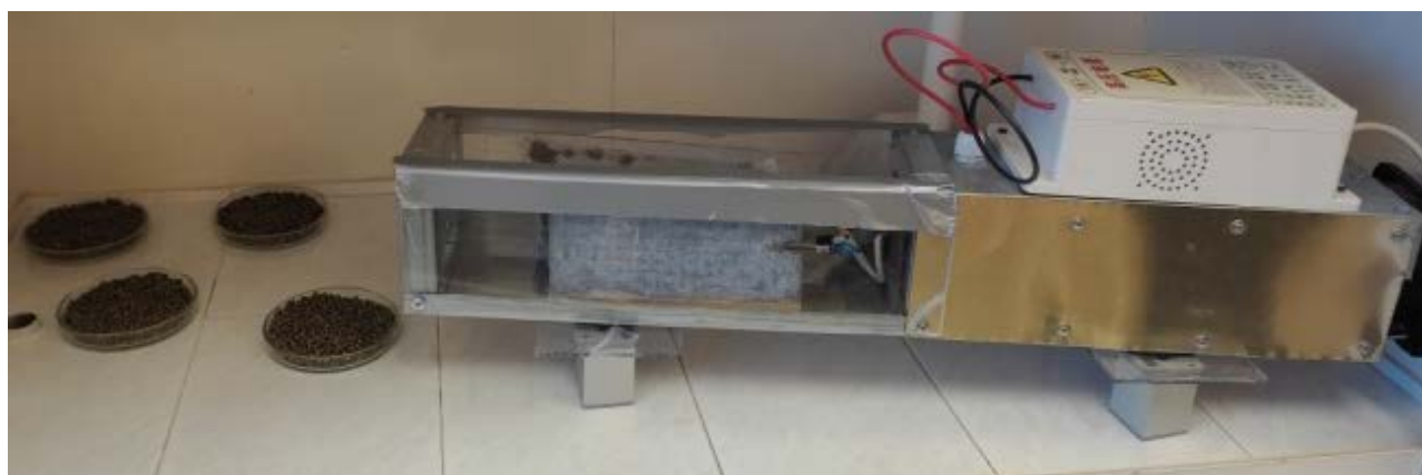
Рисунок 3.20 – Ламинарный бокс с автономным модулем электроозонатора и образцами комбикорма
