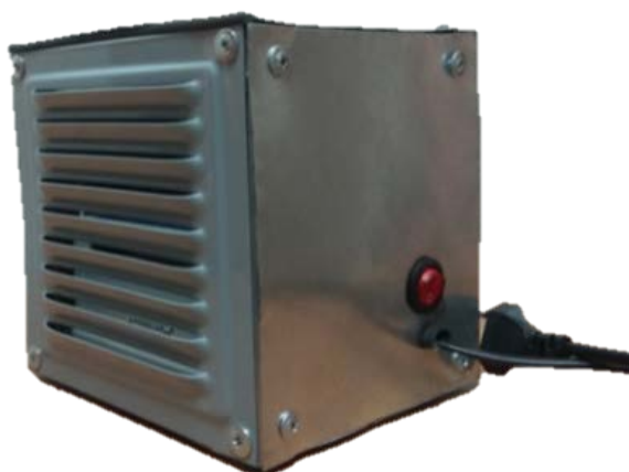
Рисунок 3.6 – Рабочий макет электроозонатора
