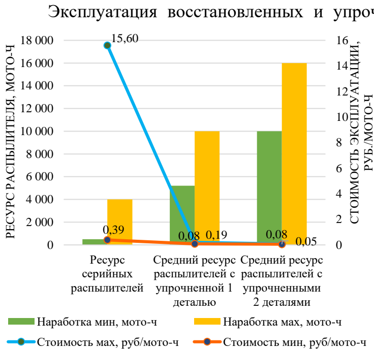
Рисунок 19 – Оценочная стоимость серийных и упрочнённых распылителей относительно ресурса.
