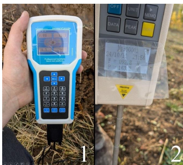
Рисунок 3.18 – Приборы для измерения параметров почвы: 1 – прибор JXBS-3001-SCY-PT, 2 – пенетрометр ALIYIQI (TYD-2)
