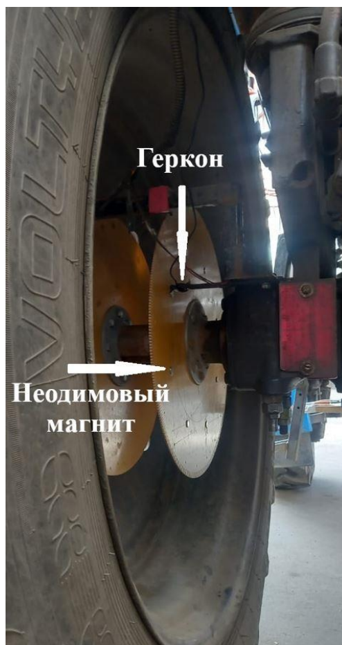
Рисунок 3.15 – Расположение специального диска, геркона и неодимовых магнитов на заднем мосту трактора МТЗ – 82
