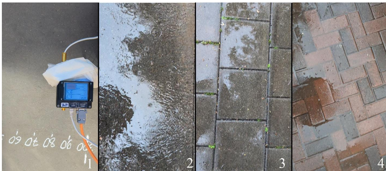
Рисунок 4.9 – Пример опорной поверхности асфальт: 1 - асфальт 2 – асфальт, покрытый водой, 3 – брусчатка тип 1, 4 – брусчатка тип 2.
