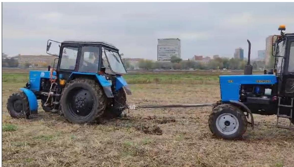
Рисунок 3.16 – Трактор МТЗ – 82 в сцепке через транспортный фал к трактору-нагрузке
