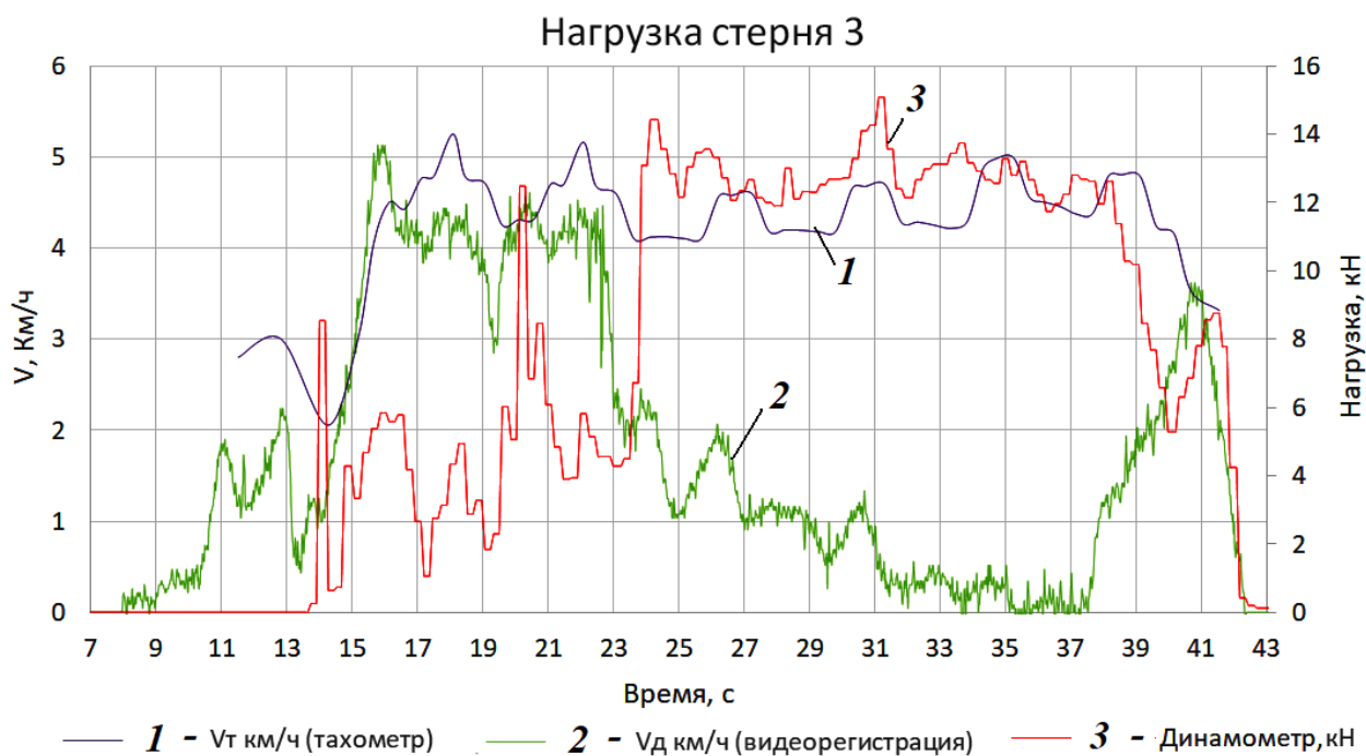
Рисунок 4.19 – Результаты исследований трактора с нагрузкой на участке – стерня: а – результат сопоставления скоростей разными устройствами; б – результат изменения теоретической скорости (1), действительной скорости (2) и тягового усилия (3).
