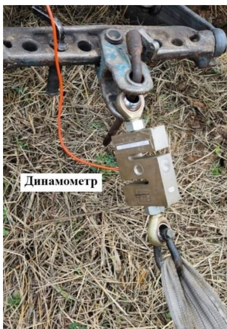
Рисунок 3.17 – Установка динамометра между трактором МТЗ - 82 и трактором-нагрузкой
