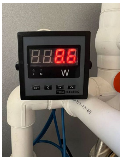
а – датчик расхода «Пульсар» Ду20; б – цифровой ваттметр TDM ЦП-ВТ72/1 SQ1102-0510; в – цифровой тахометр лазерный СЕМ АТ-6
