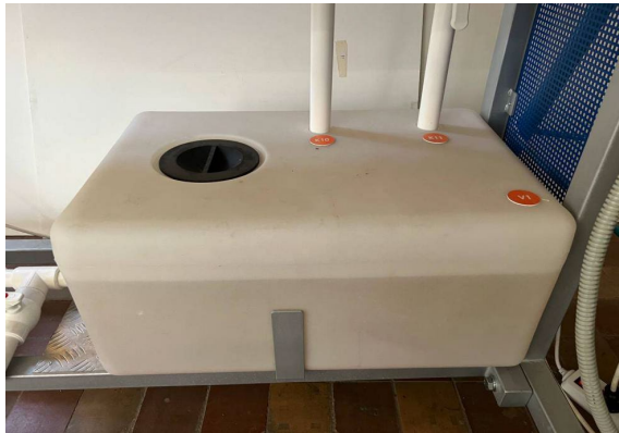
Рис. 3.2 – Бак для хранения и забора воды объемом 80 л
