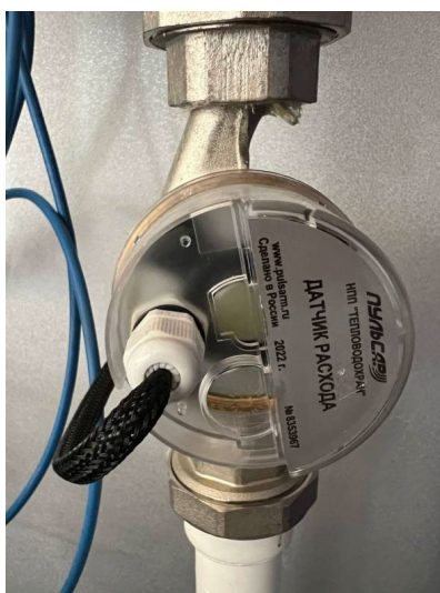
а – датчик расхода «Пульсар» Ду20; б – цифровой ваттметр TDM ЦП-ВТ72/1 SQ1102-0510; в – цифровой тахометр лазерный СЕМ АТ-6
