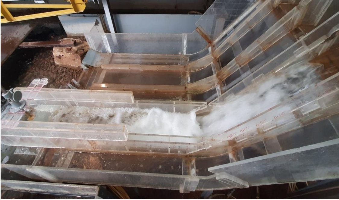
Рисунок 3.19 – Истечение при напоре 15 см и бытовой глубине 19,1 см
