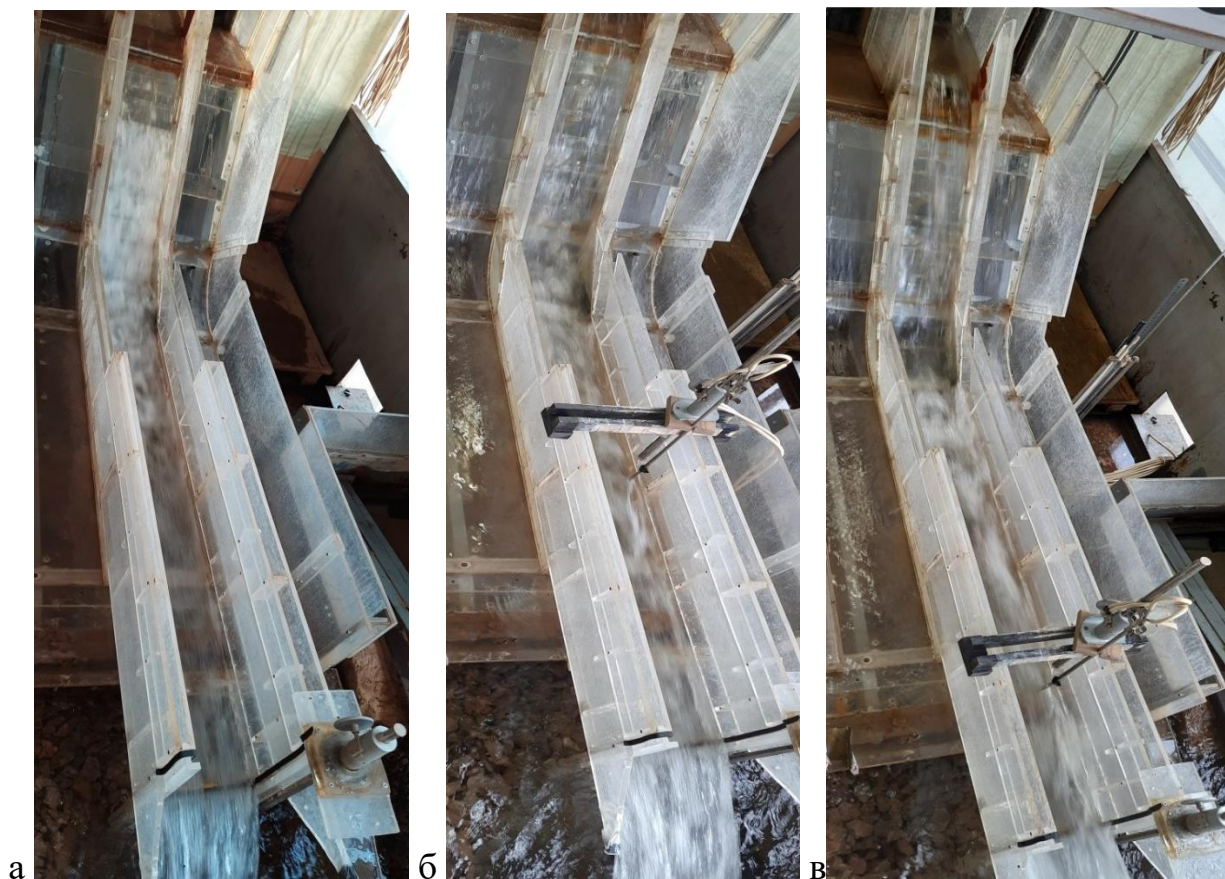
Рисунок 3.27 – Картины течения на водоскате при установке нормальных брусьев: а – H = 7,5 см; б – H = 15 см; в - H = 23 см
