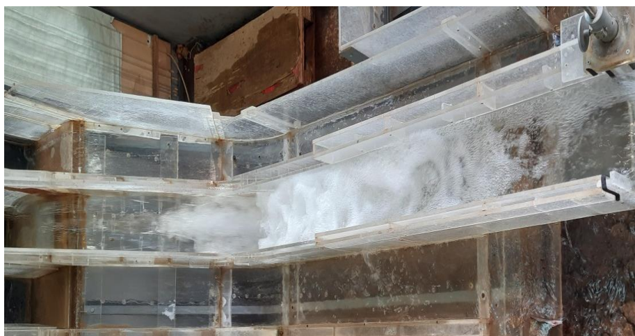
Рисунок 3.24 – Плановая картина течения потока при установке на водоскате сопротивлений в виде брусков в разбежку, напоре на гребне водослива H = 15 см и бытовой глубине в нижнем бьефе 19,4 см
