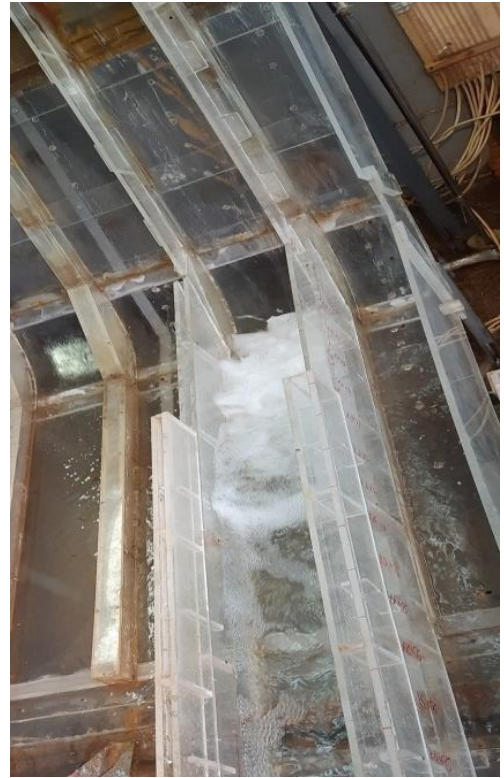
б) Напор H = 7,5\text{ см} , h_{\text{быт}} = 13,4\text{ см}
