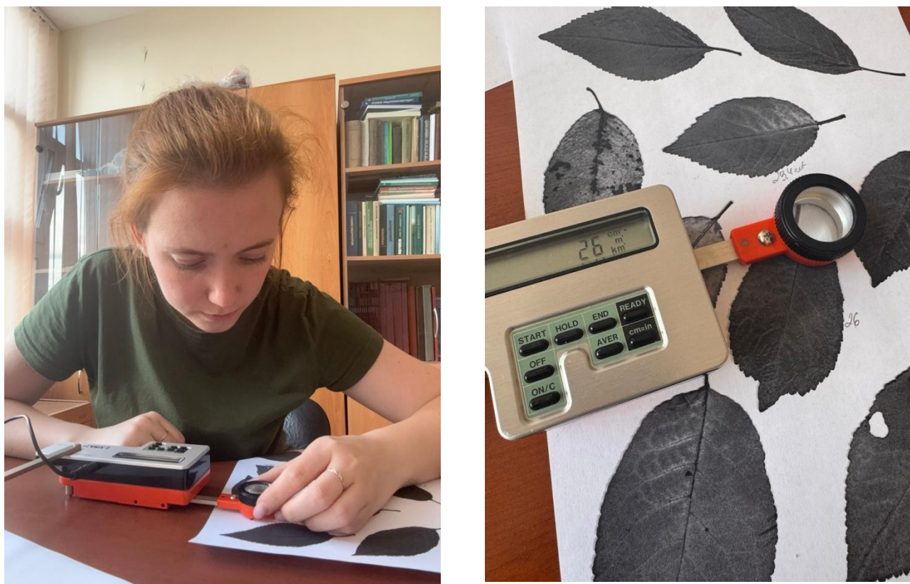
Рисунок 5.1 – Определение площади листовой поверхности при помощи электронного планиметра Planix
