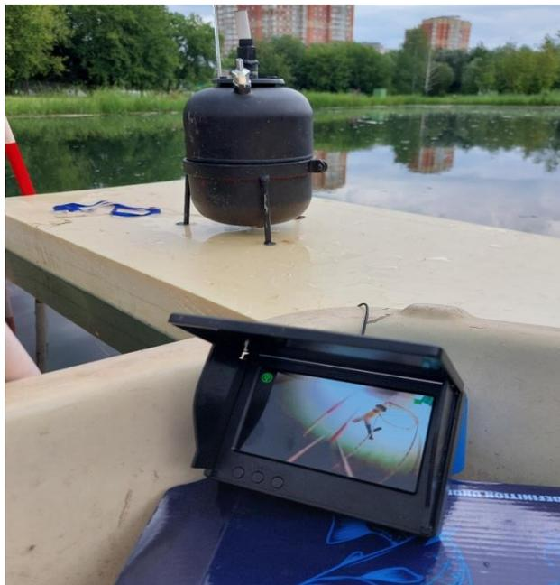
Рисунок 4.6 – Фиксация процесса выделения воздуха из устройства с использованием видеокамеры
