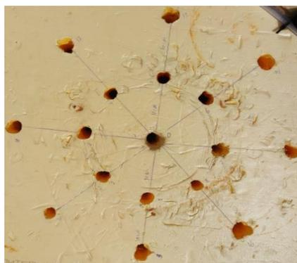
Рисунок 4.9 – Поплавок с размещением отверстий для установки датчика оксиметра
