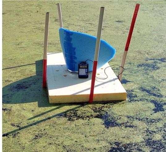
Рисунок 4.7 – Экспериментальная установка с колпаком для оценки содержания РК в условиях резервного пруда
