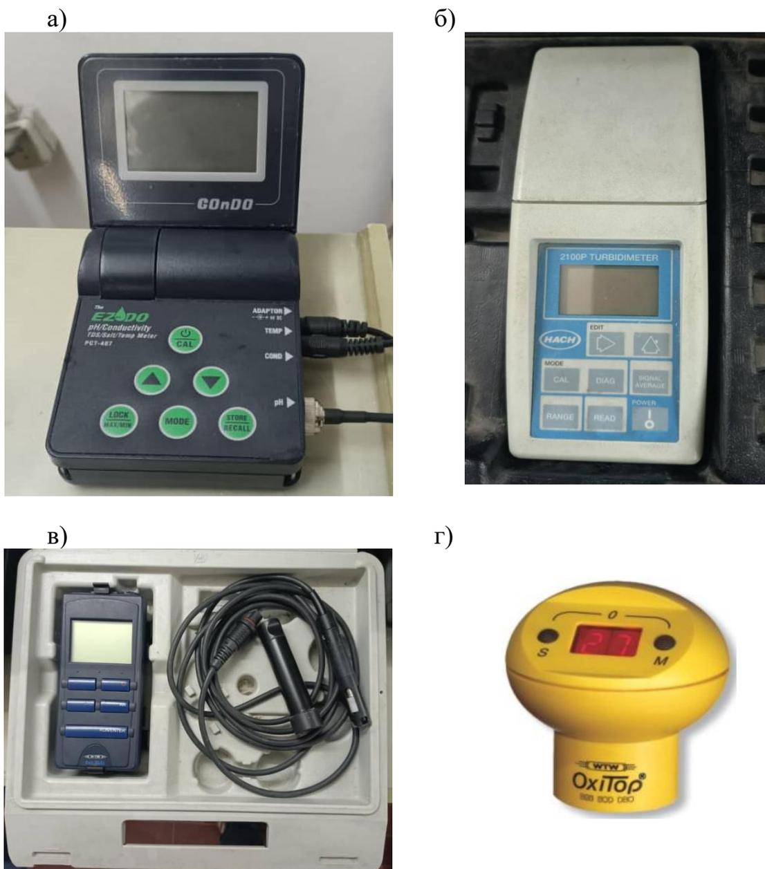
а –  $pH$ -метр «EZODO PCT-407»; б – мутномер «HACH 2100P Turbidimeter»;
