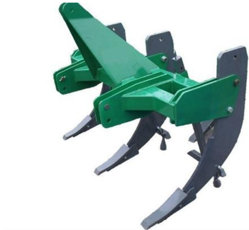
Рисунок 21. Рабочий орган для щелевания почвы [61].
