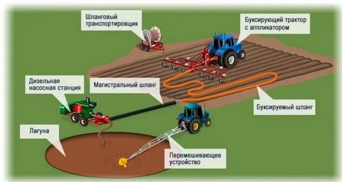
Рисунок 17. Принципиальная схема внесения стоков животноводческих комплексов в почву шланговой системой [54].
