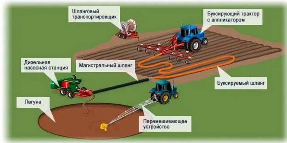
Рисунок 2 – Принципиальная схема внесения стоков животноводческих комплексов в почву шланговой системой.
