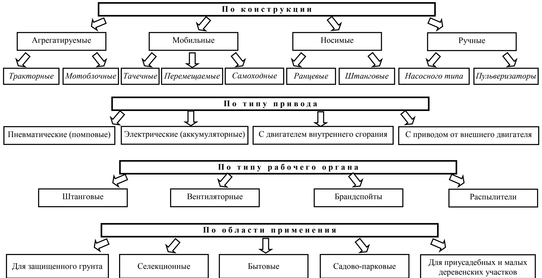
Рисунок 1.6 - Классификация малогабаритных опрыскивателей
