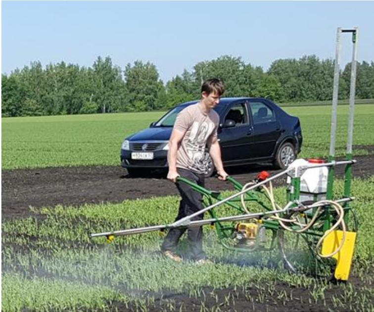
Рисунок 8 – Полевые испытания распределяющей системы одноопорного штангового мотоопрыскивателя
