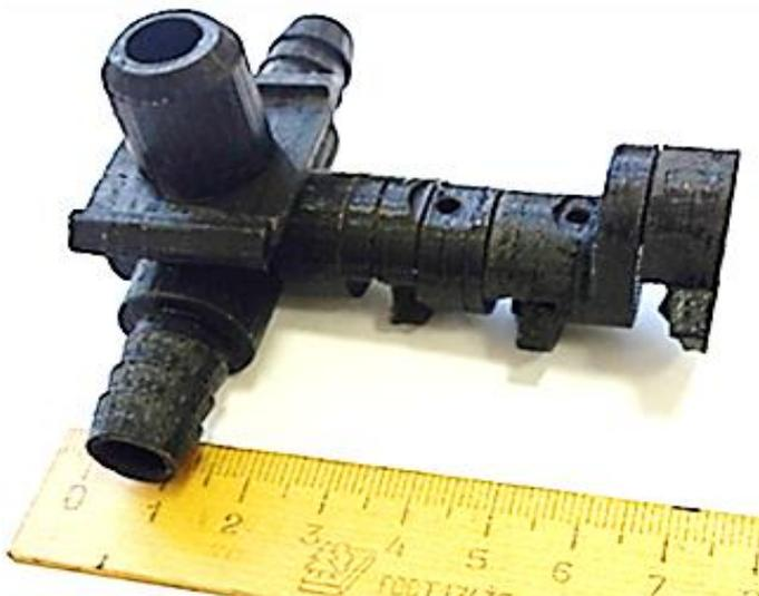
Рисунок 5 – Общий вид опытного образца многорежимного распылителя
