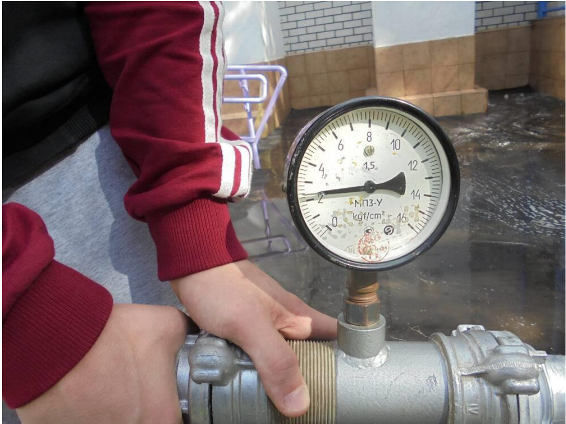
Рисунок 3.8 – Манометр для определения напора рабочего потока перед струйным аппаратом
