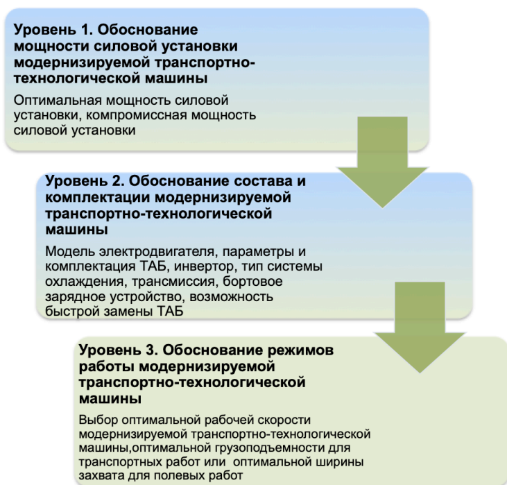
Рисунок 2 – Методика обоснования параметров модернизируемой машины как многоуровневая система
