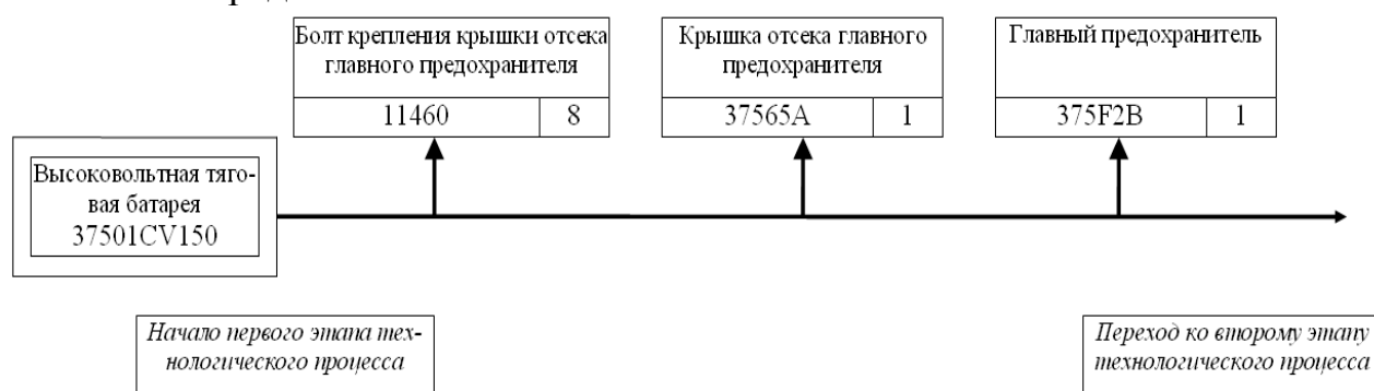
Рисунок 8 – Фрагмент схемы технологического процесса на примере первого этапа (демонтаж главного предохранителя)
