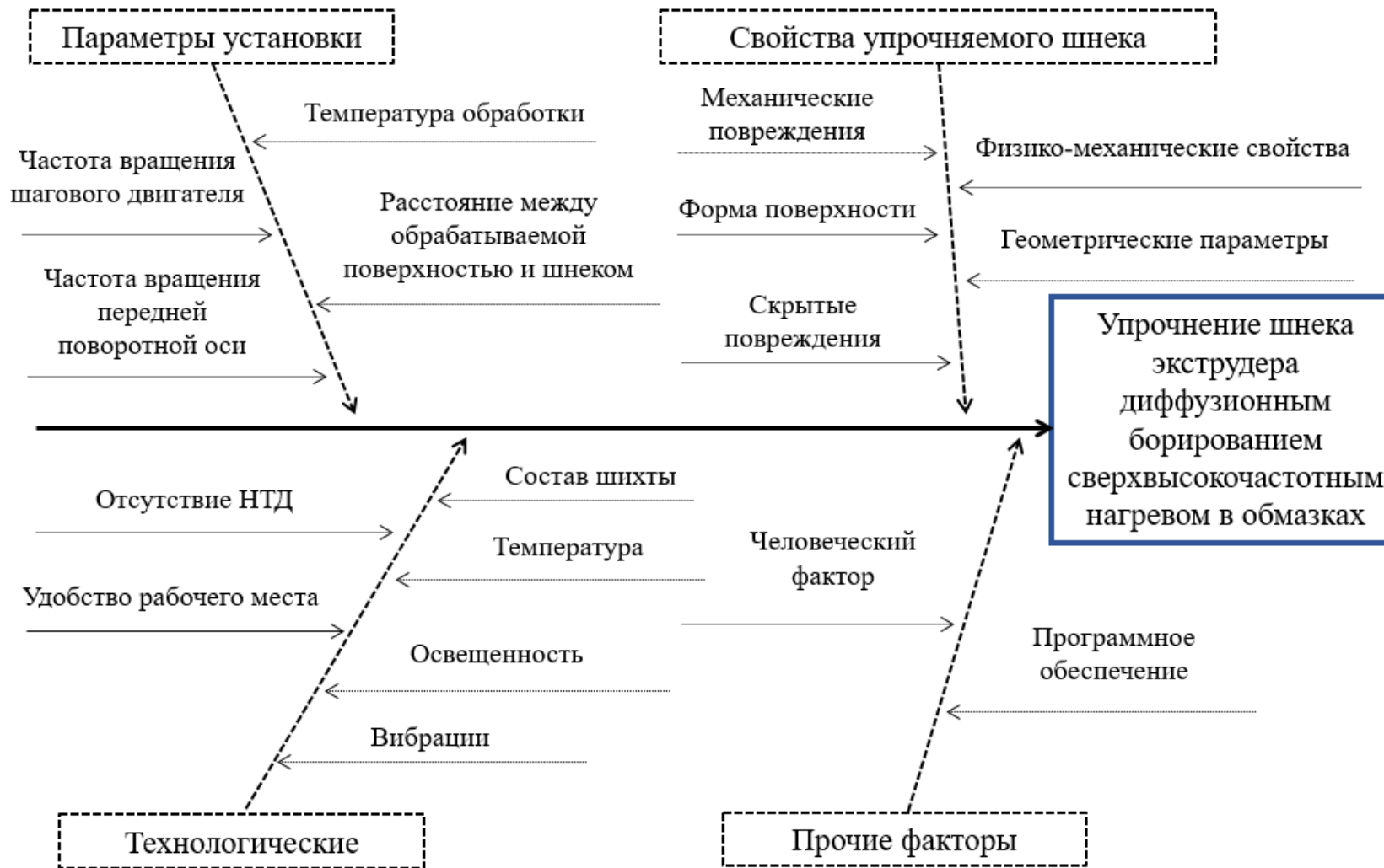
Рисунок 2.7 – Факторы, влияющие на упрочнения шнека экструдера диффузионным борированием сверхвысокочастотным нагревом в обмазках
