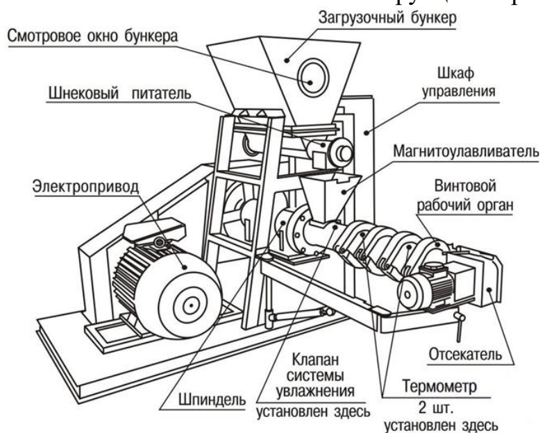
Рисунок 1.8. - Устройство кормового вливатель.
