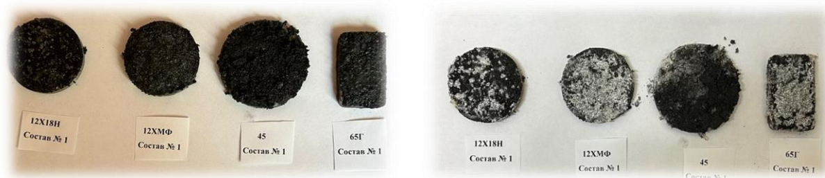
Рисунок 3.11 - Экспериментальные образцы с нанесённой шихтой до и после сушки.
