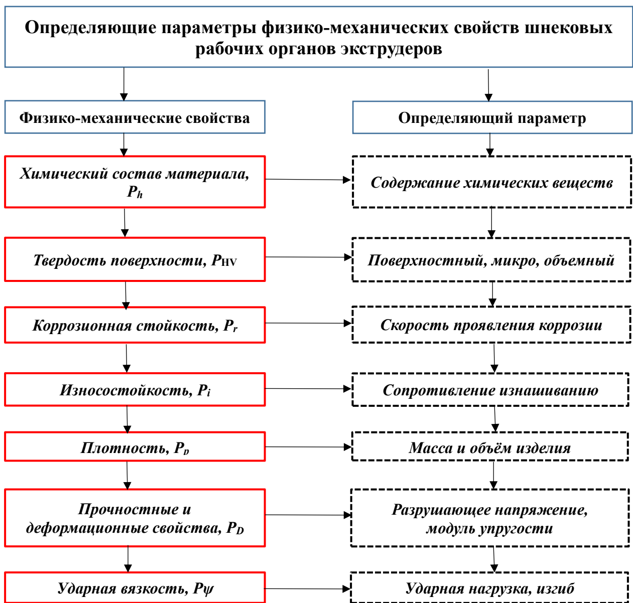
Рисунок 2.3 – Определяющие параметры физико-механических свойств шнековых рабочих органов экструдеров
