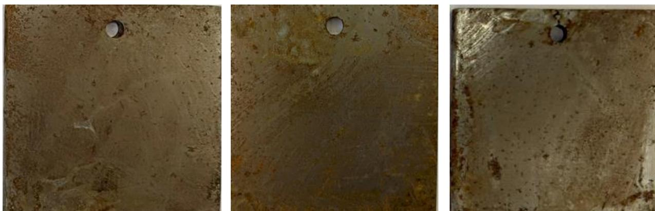
Рисунок 4.16 – Фотографии образцов стали Ст3 после экспозиции в течение 6 месяцев
