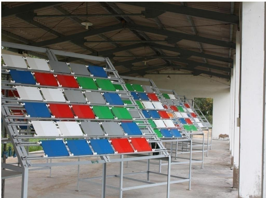
Рисунок 3.9 – Пример открытого стенда, расположенного под навесом
