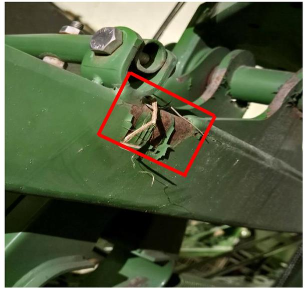
Рисунок 1.3 – Коррозионные поражения навесного опрыскивателя Amazone UF
