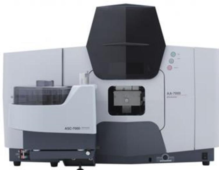
Рисунок 3.6 – Атомно-абсорбционные спектрофотометры AA-7000
