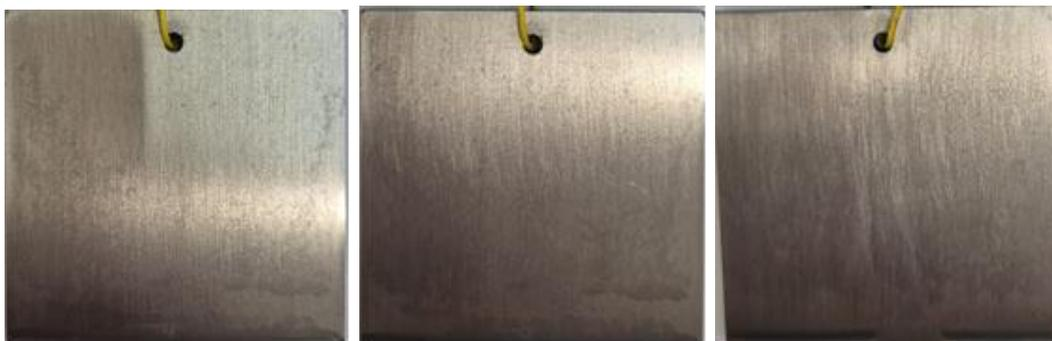
Рисунок 4.9 - Опытный образец после испытания (без удаления продуктов коррозии)
