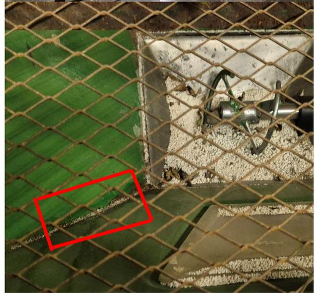
Рисунок 1.4 - Коррозионные поражения разбрасывателя удобрений AMAZONE
