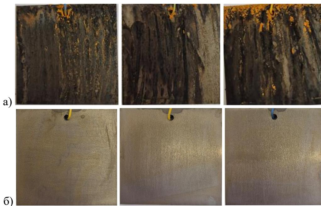
Рисунок 4.8 - Контрольный образец после испытания (без удаления продуктов коррозии)
