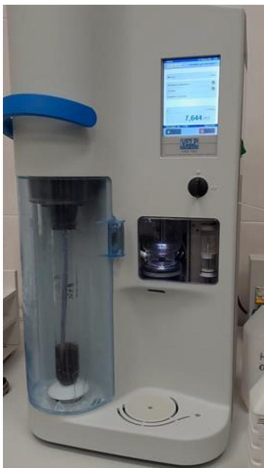
Рисунок 3.3 – Автоматический анализатор азота/белка VELP UDK 169
