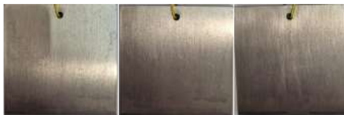
Рисунок 5 - Опытный образец после испытания (без удаления продуктов коррозии)
