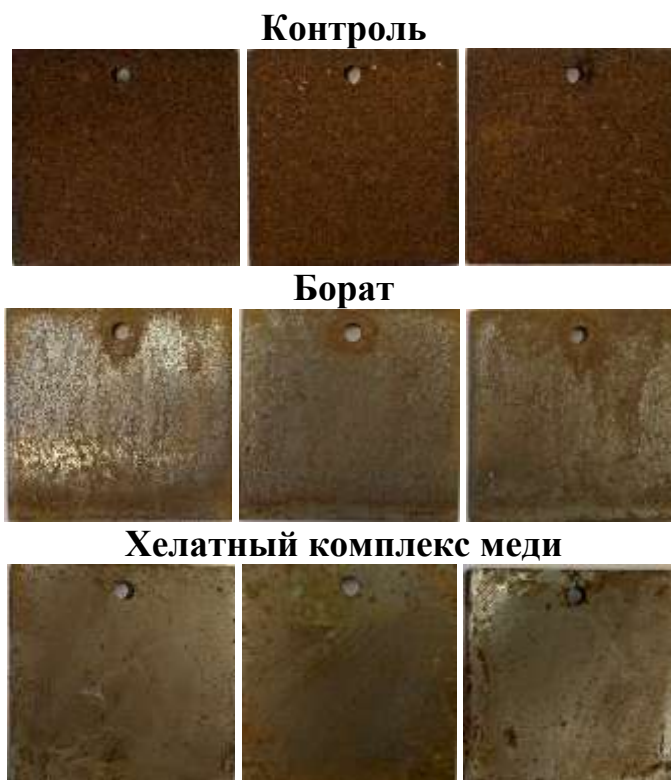
Рисунок 7 – Фотографии образцов стали Ст3 после экспозиции в течение 6 месяцев
