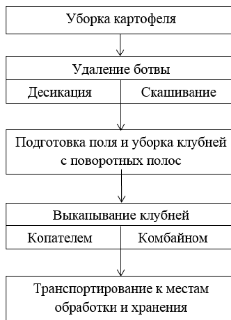
Рисунок 1.5 – Технологическая схема уборки картофеля [57]
