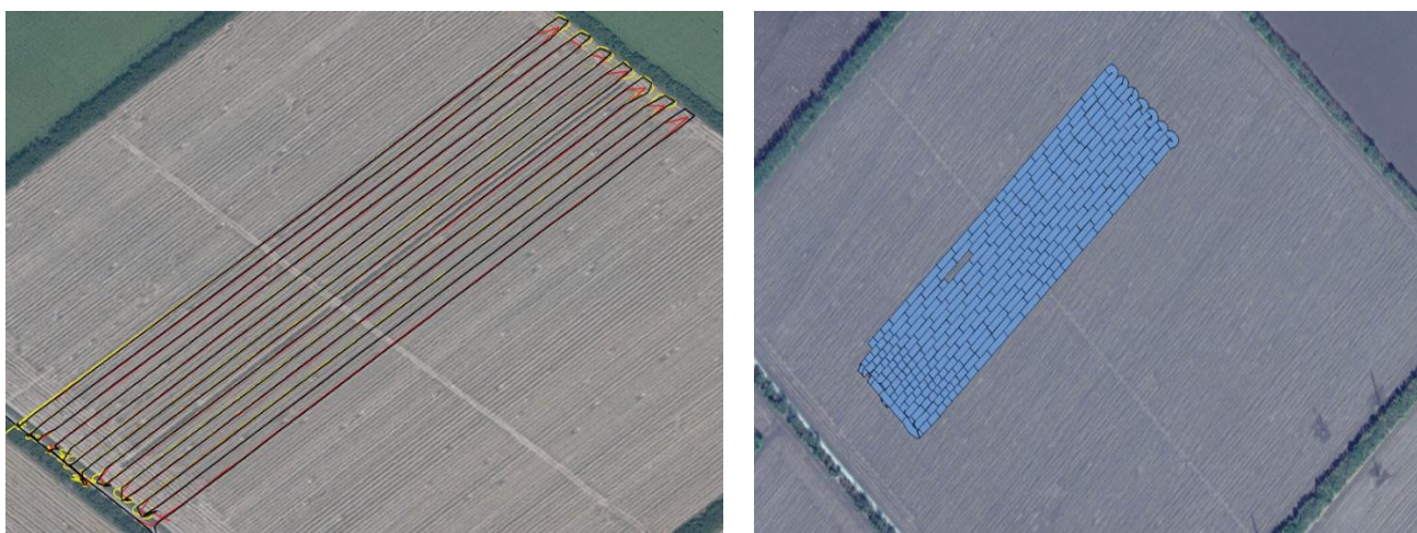
Рисунок 2.14 – Трек движения техники, с учётом прицепного ширины [6]
