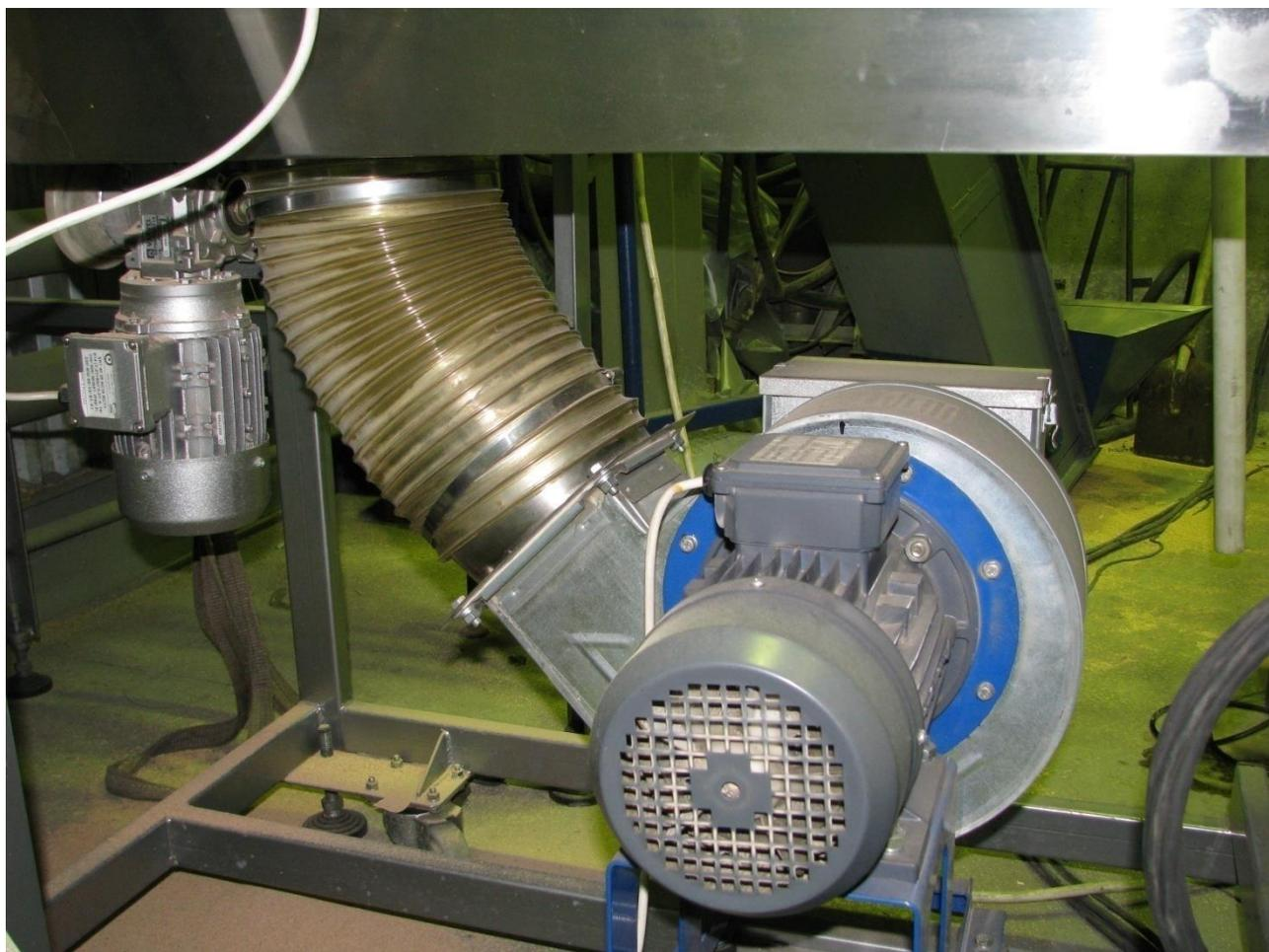
Рисунок 5.8 – СВЧ-установка с воздухонагревателем в процессе монтажа
