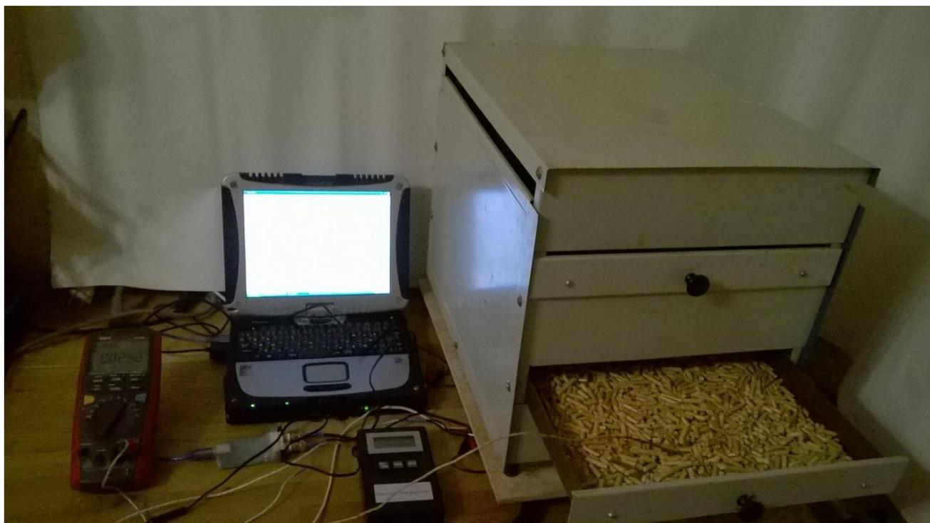
Рисунок 3.15 – Установка для анализа интенсивности влагоудаления
