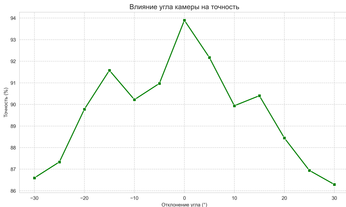
Рисунок 5.2 — Влияние угла камеры на точность идентификации
