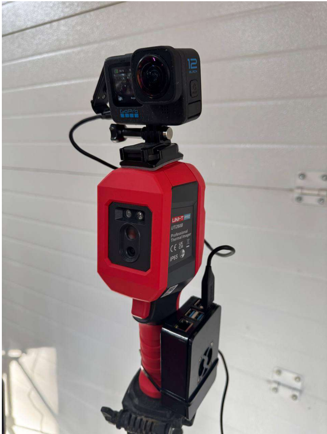
Рисунок 3.4 — Прототип системы: тепловизор, камера и одноплатный компьютер Raspberry Pi
