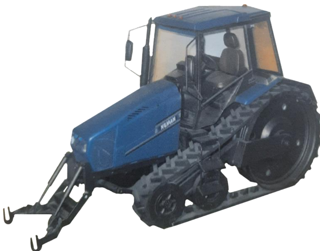
Рисунок 7.3 – Макет в масштабе 1:5 с реализацией конструктивного решения быстросъемной замены колесного движителя на гусеничный
