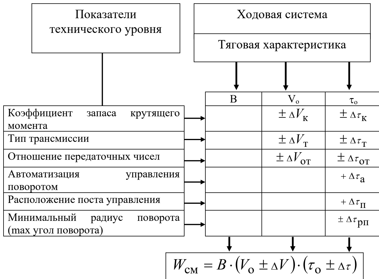
Рисунок 6 – Последовательность учета показателей технического уровня трактора при моделировании сменной производительности пахотного агрегата
